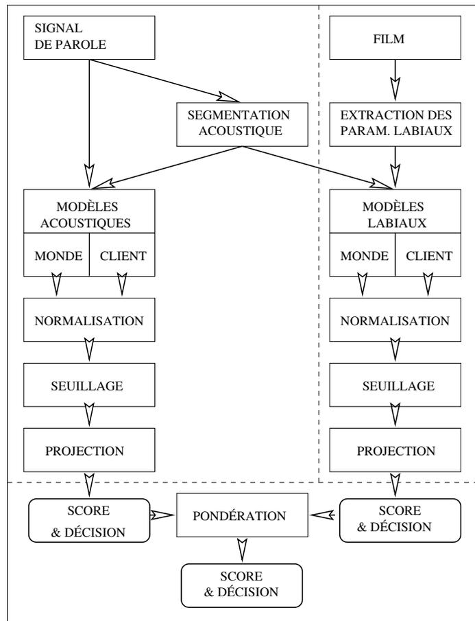
FIG. 4.7: Schéma de la vérification acoustico-labiale du locuteur.
