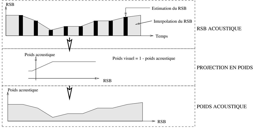
FIG. 2.4: Estimation d'un poids acoustico-labial, en fonction du rapport signal sur bruit et suivant Meier et al. (1996)
