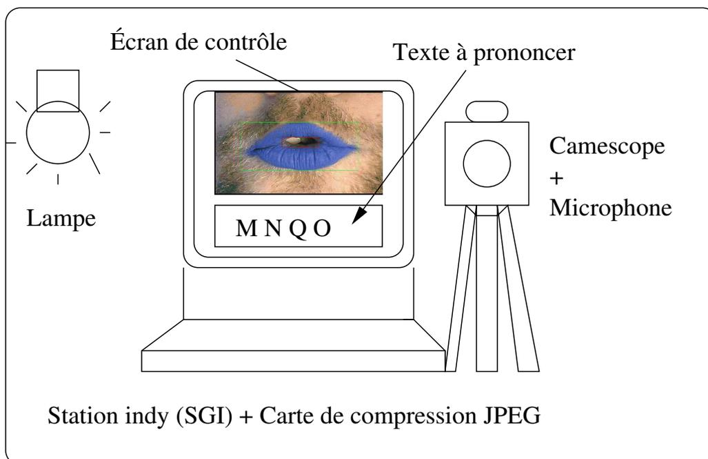
FIG. 3.2: Schéma du système d'acquisition audiovisuelle du LIA
