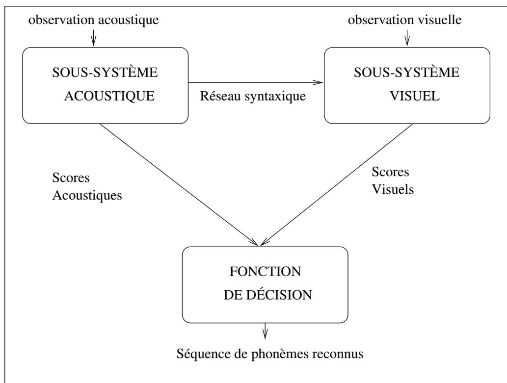
FIG. 1.1: Schéma du système N-MEILLEURES de Alissali et al. (1996)
